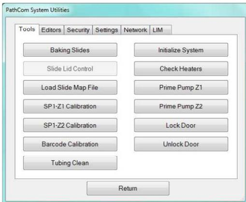
5. Le sonde Z1 e Z2 aspireranno 5 mL di soluzione pulente nei tubi dalle rispettive posizioni nel porta reagenti. Il sistema avvierà un conto alla rovescia di 20 minuti.
