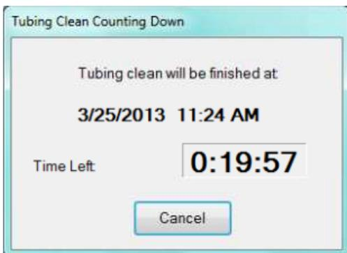
Una volta trascorso questo periodo di tempo, il sistema eseguirà in automatico una procedura di inizializzazione ed eliminerà gli scarti della soluzione pulente. *L'utente può cliccare su "Annulla" in qualsiasi momento per eliminare immediatamente gli scarti dai tubi.* Controllare i tubi. Non devono presentare residui visibili di cera, accumuli di precipitato di DAB o sali. Ripetere la funzione Pulizia tubi in base alle necessità.
